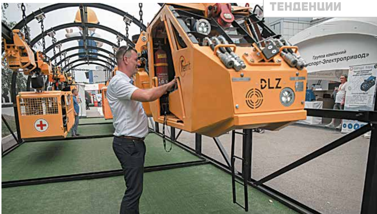
Компания «Сибтранссервис», официальный представитель чешской фирмы Ferrit в России, представила на выставке очередную новинку: двухприводный облегченный дизель-гидравлический локомотив DLZ50F для работы в дальних проходческих выработках. Он экономно расходует топливо и меньше выделяет в шахтовую атмосферу углекислого газа
