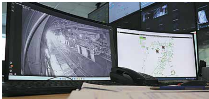
Валерий Черепков показал на мониторе, как с помощью мнемосхемы можно отследить транспорт под землей
