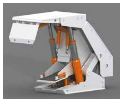
Секция механизированной крепи для реализации технологии с управляемым выпуском угля
